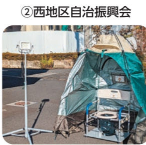
▲防災備品(投光器・マンホールトイレなど)
